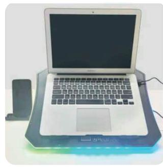
4. Соедините подставку и ноутбук с помощью кабеля, отрегулируйте скорость вращения вентиляторов.
